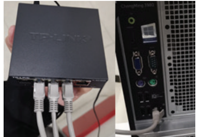
Рисунок 44 — Подключение сетевых кабелей
