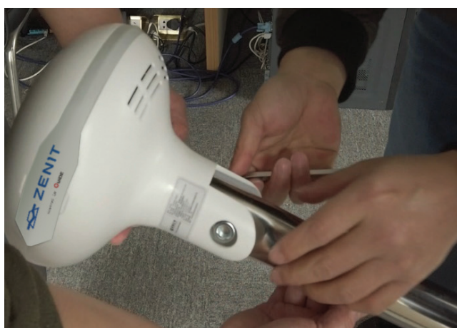
Рисунок 30 — Установка головной части камеры
