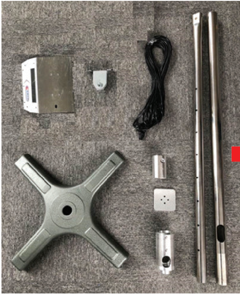
Рисунок 32 — Составные части для сборки абсолютно черного тела
