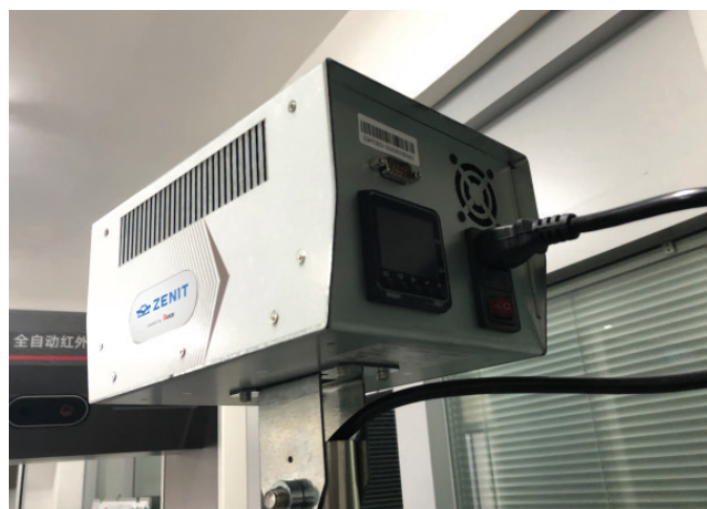
Рисунок 40 — Подключение кабеля в разъем питания
