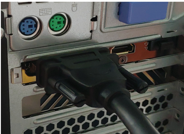
Рисунок 45 — Подключение графической карты
