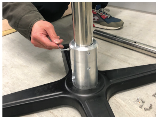
Рисунок 25 — Установка и крепление штанги к шасси
