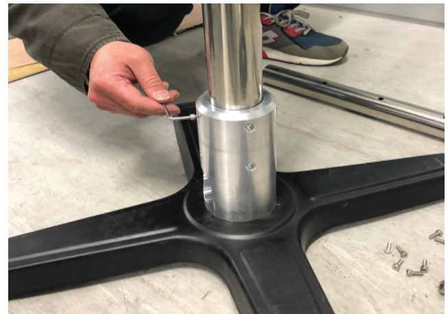
Рисунок 34 — Установка и крепление штанги к шасси
